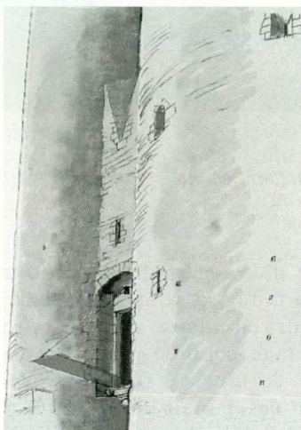
Figure 13. Détail de la porte à pont-levis de la tour, croquis restititif, sous le même angle que la figure 12.
